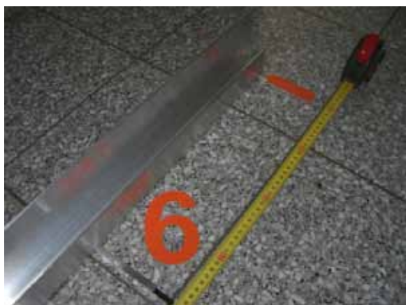
Messanordnung (Ebenheitstoleranz (Messkeil))
