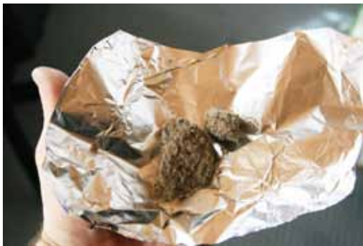
Estrichprobe wird in Alu-Folie „locker“ eingeschlagen
