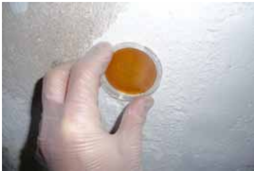
Probenahme eines Abklatsches mit Abklatsch-Agar (Petrischale)
